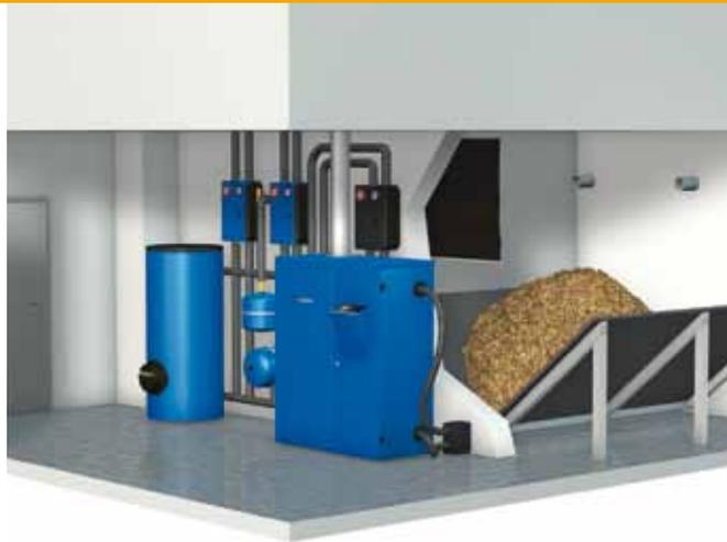
M4 Pelletheizkessel mit Vorratsbehälter
