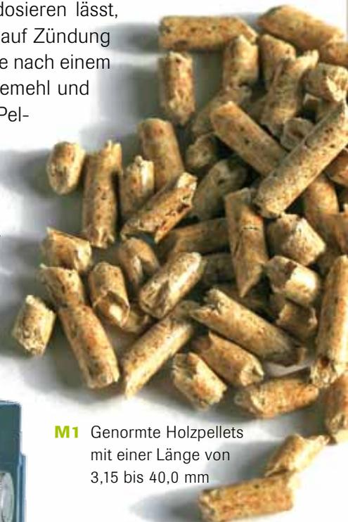
**M1** Genormte Holzpellets mit einer Länge von 3,15 bis 40,0 mm
